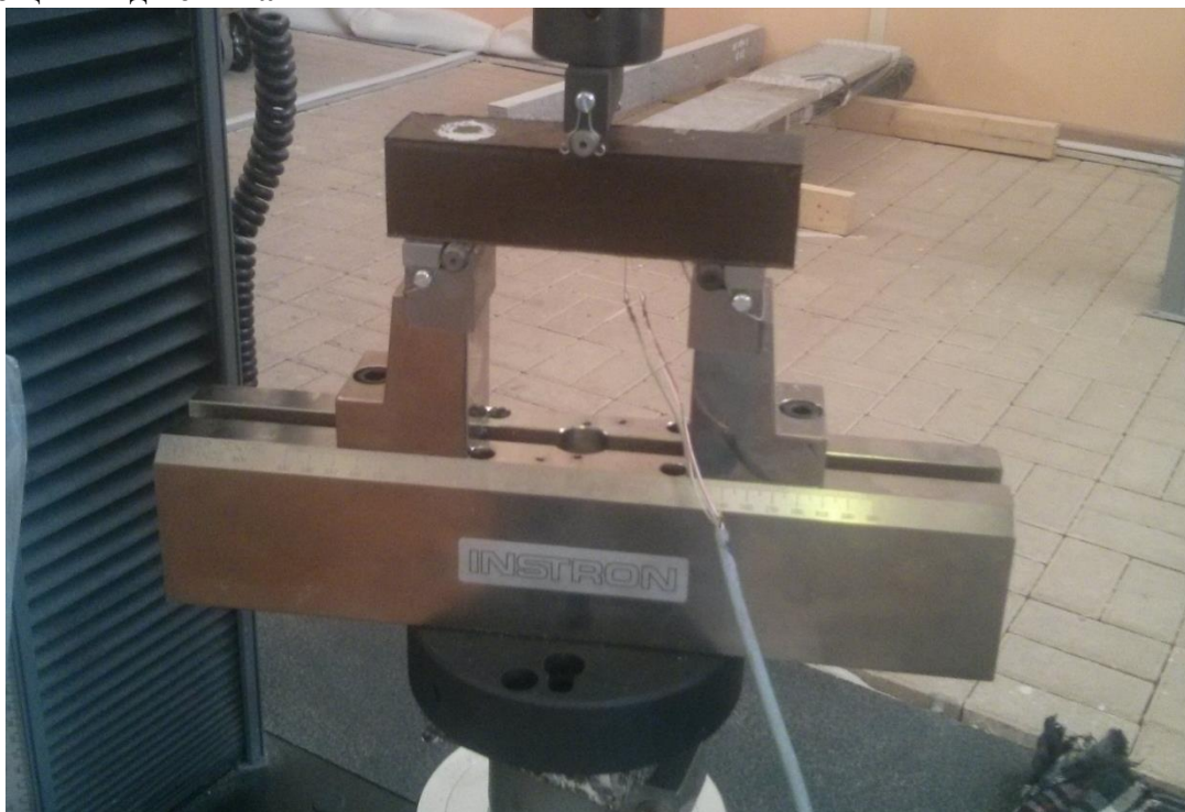
Рисунок 3 – Схема загрузки экспериментальных балок
